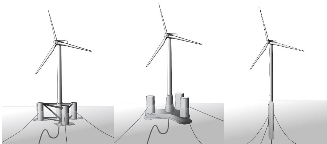
Figur 7: Eksempler på flytende fundamenter, Halvt nedsenkbare (semisubmersibles) til venstre og i midten, spar plattform til høyre. Nielsen (2024). Kopiert med tillatelse fra Cambridge University Press.
