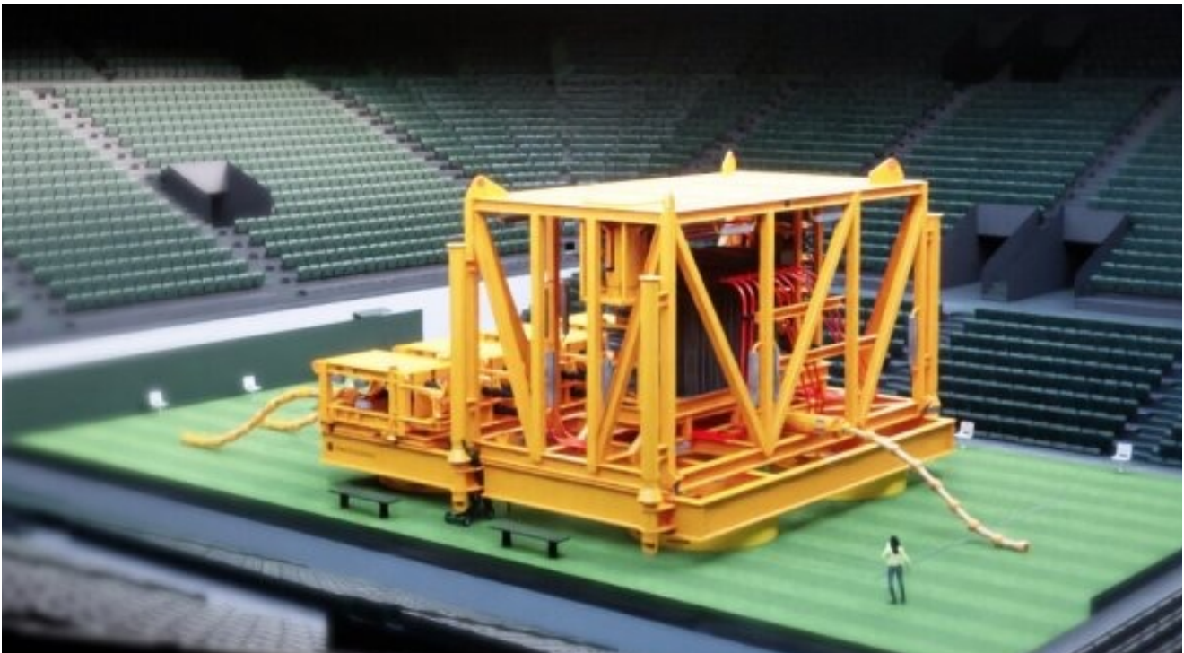
Figur 22: Eksempel på 400 MVA Subsea Substasjon med 66 kV inn (4 stk) og 220kV ut.
