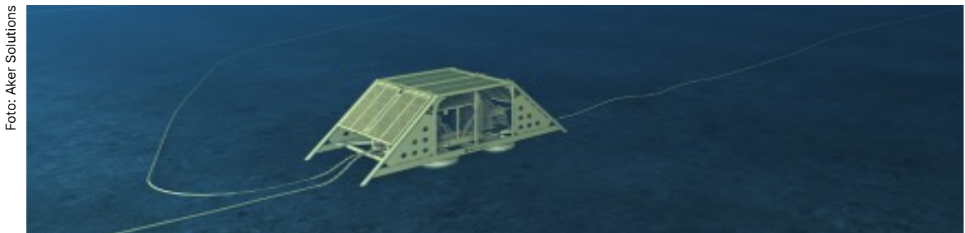
Figur 29: Eksempel på overtrålbare struktur for bedre sameksistens med fiskeriaktivitet (Bilde: Aker Solutions)
