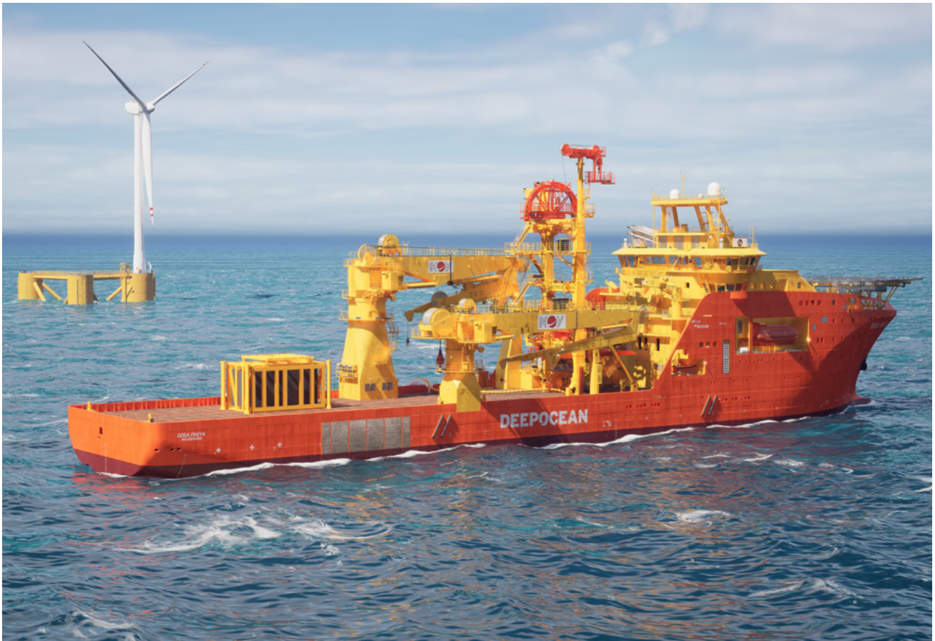
Figur 25: Installasjon av 66 kV IAC kabler og subsea transformator.
